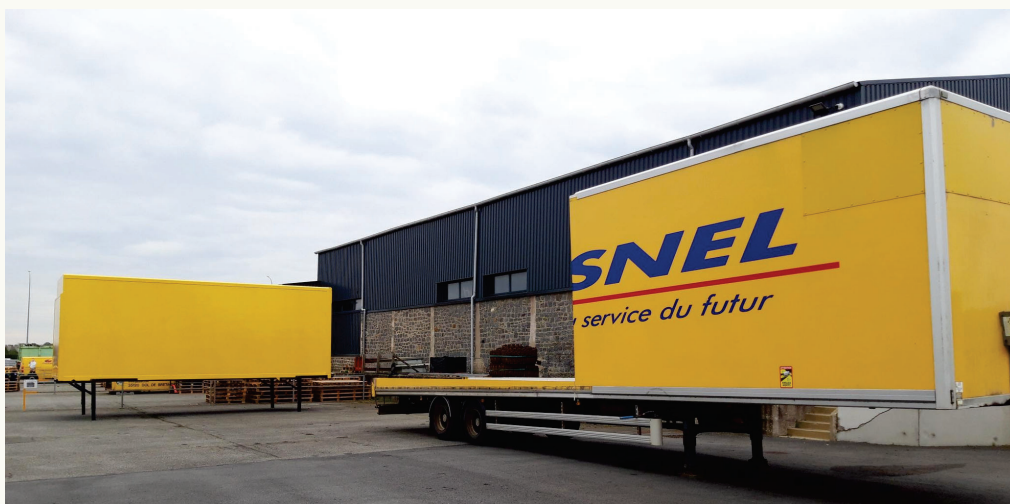
Semi-remorque découpée par notre carrossier Rouillé pour en faire des caisses-mobiles.
